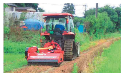
農機に付着した茎断片が拡散しない作業手順の工夫（未発生ほ場→多発ほ場）。機械洗浄の励行
