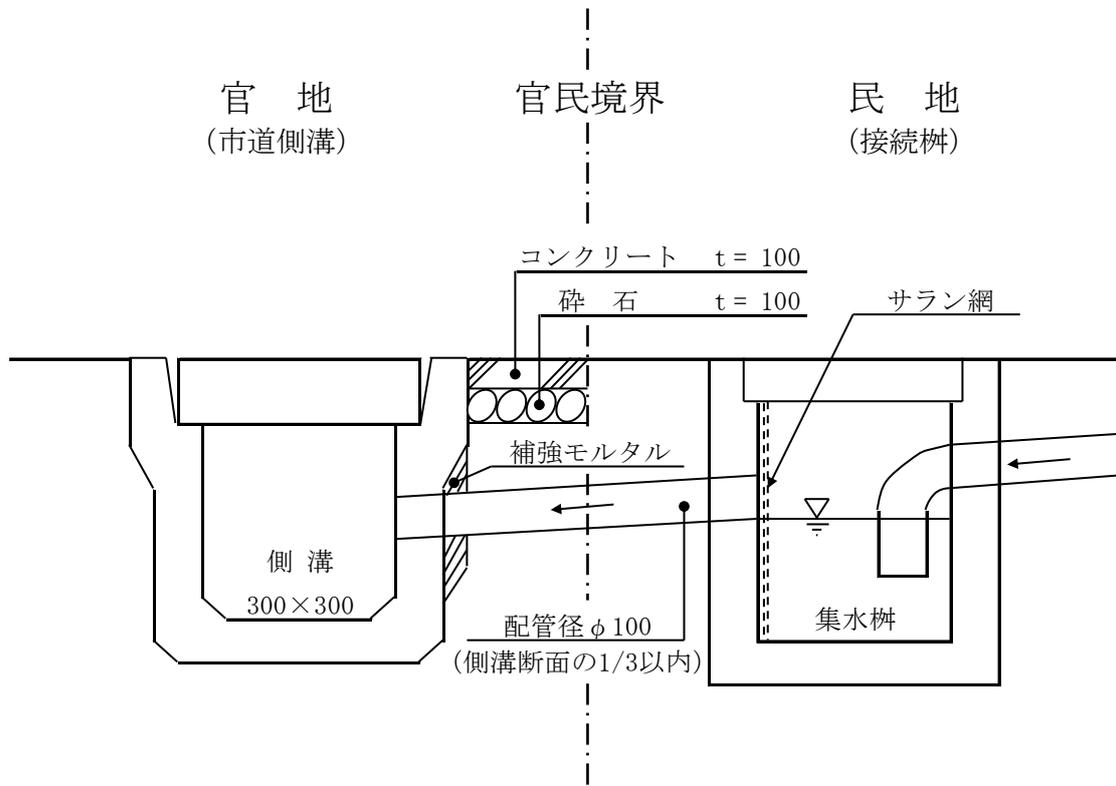
※ 市側溝への流入の際は、汚物等の流入を防ぐため、サラシ網を備えた集水柵（450用）を設置すること。
