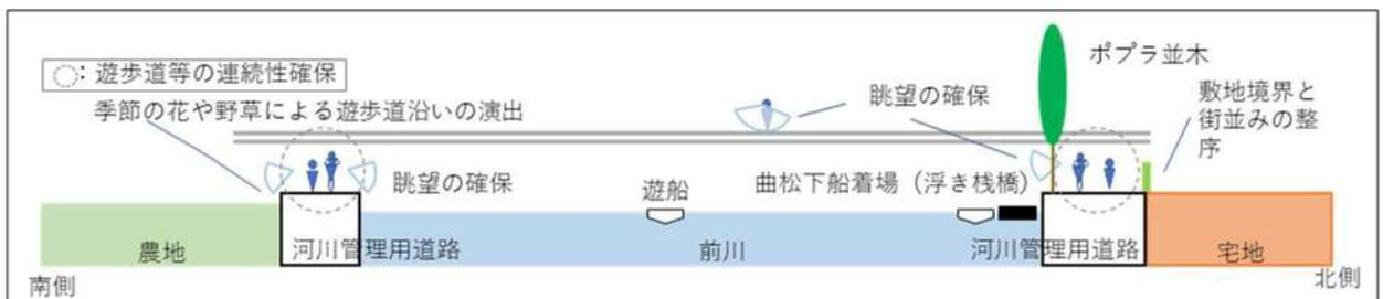
図 12 曲松下付近の断面構成（断面③）
