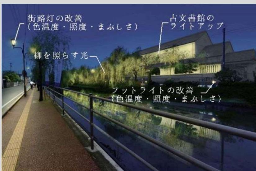
掘割越しに柳川立花邸を眺める歩道の照明。輝度を抑えた街路灯や、間接光を使った明かりを用いている。色温度を統一し、落ち着いた風景を醸し出している。
