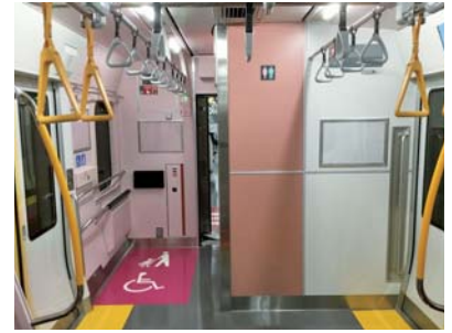
【バリアフリースペース・ 車いす対応トイレ】
