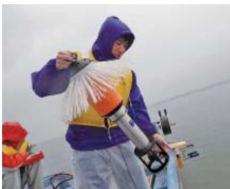
観測で用いている最新鋭の観測装置YODA Profiler (水温、溶存酸素、植物プランクトン分布を高精度に計測できる観測装置)
