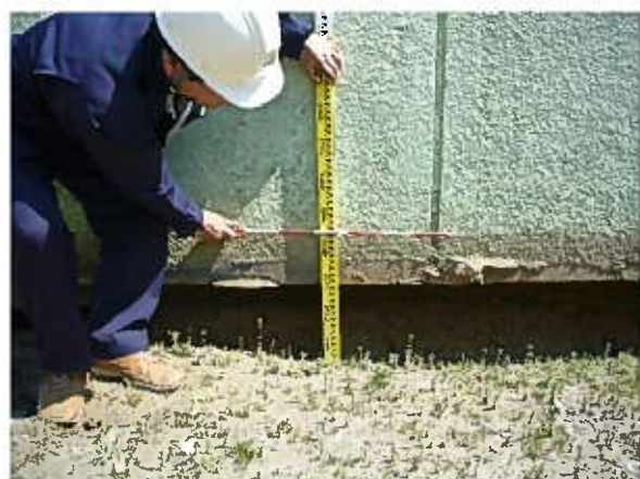
写真 1. 4-18 地盤の沈下量 45cm
