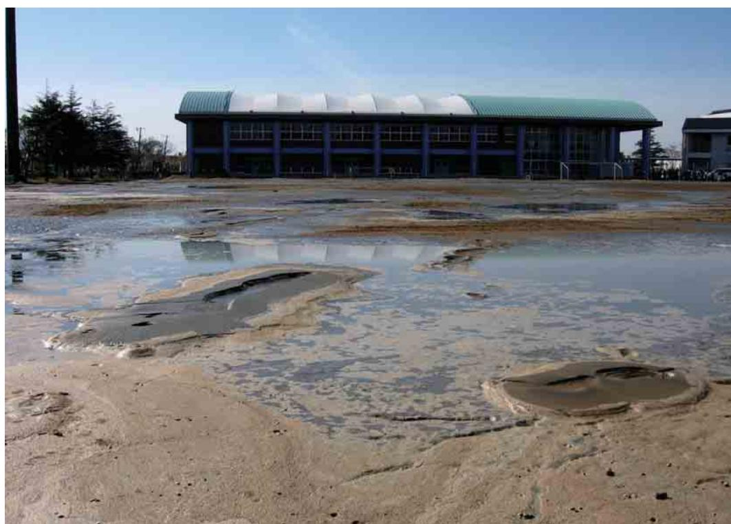
液状化により土砂が吹き上がった後の日の出中学校グラウンド
